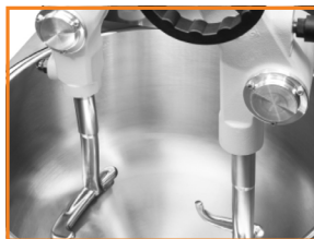
Brazo de inmersión ajustable y parte superior en hierro fundido (TWINTeCH 40-60)
