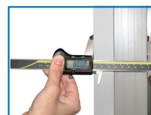
Aislamiento ecológico con 80 mm de espesor
