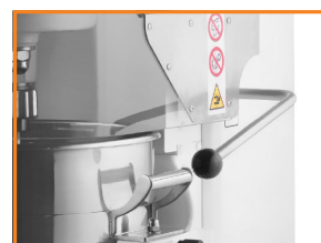
Palanca para elevar cuba en modelo 60
